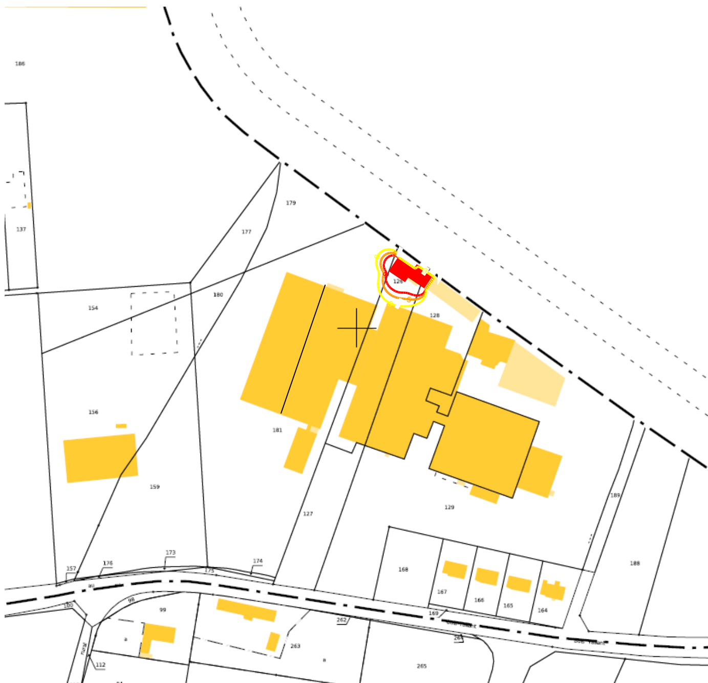
Plan 7 : représentation des zones de flux thermiques à 1,5 m d'altitude en cas d'incendie généralisé du local de stockage des consommables et d'équipements de protection individuels après extension dans la configuration initialement prévue sans mur coupe-feu (1/2 000ème)
